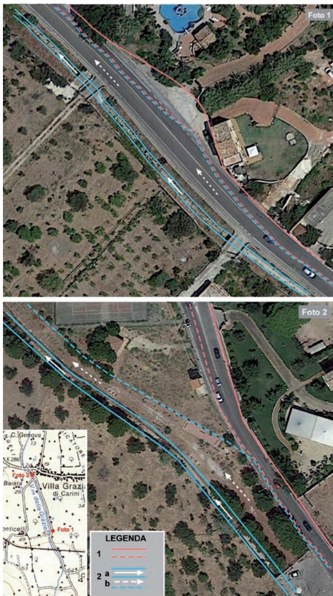
Fig. 3 — Confronto tra l'antico e il nuovo tracciato dell'alveo del Torrente San Vincenzo-V.ne della Grazia (tratto A-B di Fig. 2). Legenda: 1. Tracciato originario della ex “regia Trazzera della Grazia”; 2. a) alveo attuale, b) alveo originario./Comparison between previous and new San Vincenzo-V.ne della Grazia stream (A-B stretch, Fig. 2). Legend: 1. Former “Regia trazzera della Grazia” road; 2. a) current stream, b) former stream.
